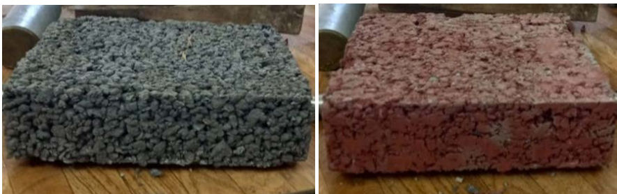
Slika 4. Serija 03. Porozne betonske ploče sa andezitom. Maseni udeo modifikovanog SWWTS u ispitivanim uzorcima: sivi 0%, crveni 30%.
