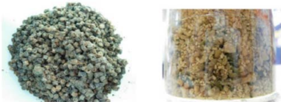
Slika 2. Fotografije biomase priložene u SBBGR sistem (levo) i granule zatvorene u pore (desno) (Tomei, 2016)
