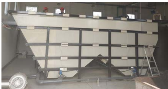
Slika 5. Lamelarni taložnik Figure 5. Lamella settler
