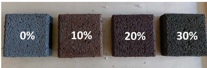
Slika 3. Serija 01. Porozne ploče i lakoagregatnog betona od ekspanzirane gline. Maseni udeo SWWTS u ispitivanim uzorcima: sivi 0%, braon 10%, crveni 20%, zeleni 30%.
